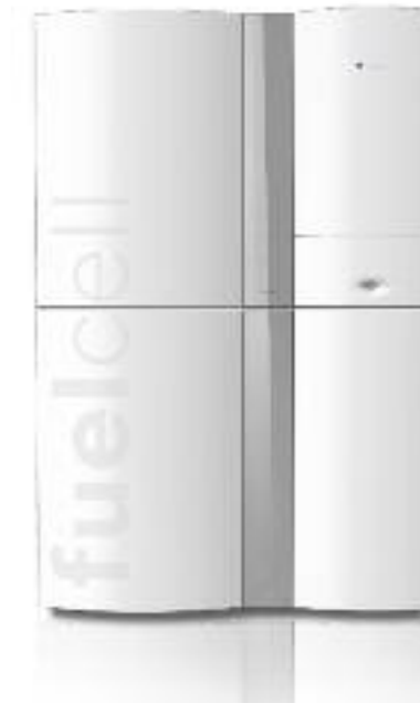
Junkers hat in 2016 die CeraPower FC auf Brennstoffzellenbasis eingeführt. In einem Gehäuse integriert: Ein bewährtes und tausendfach erprobtes Gas-Brennwertgerät, eine innovative Brennstoffzelle sowie zwei Speicher für die effiziente Bevorratung des erwärmten Trink- und Heizwassers. Mit Abmessungen von 1800 x 1200 x 600 Millimetern (H x B x T) ist die CeraPower FC sehr kompakt.
